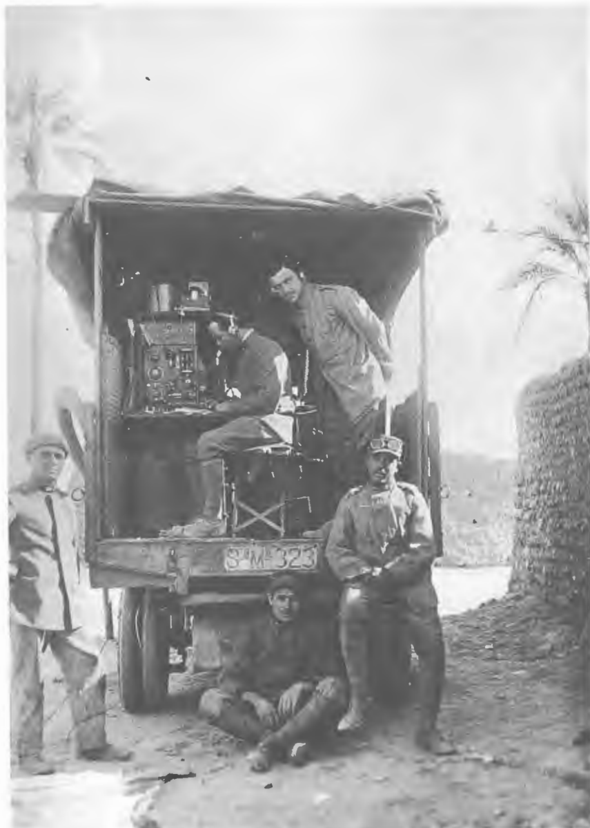
La stazione radiotelegrafica della colonna montata su di un autocarro
